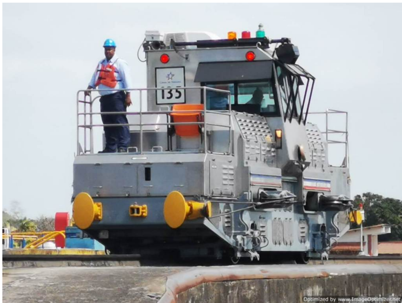
maquina eléctrica que remolca cargueros
